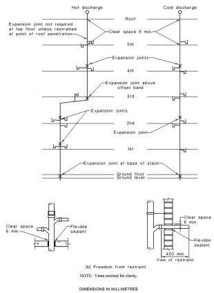
EXPANSION JOINTS IN COPPER AND COPPER-ALLOY STACK
